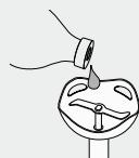
Dacă pe durata funcționării apar zgomote neobișnuite precum scârțâit sau zgomote asemănătoare, aplicați puțin ulei alimentar neutru pe arborele de antrenare al piciorului pasator ④.
